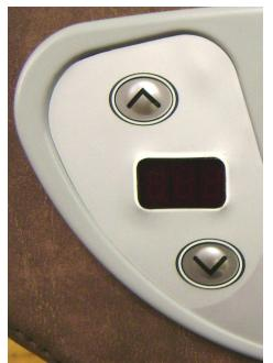
Чтобы установить желаемую температуру, нажмите один раз на кнопку понижения или повышения температуры для индикации текущей температуры в чаше спа. Для изменения температуры воспользуйтесь кнопками повышения (L) или понижения (V). Установленное значение температуры будет высвечиваться на дисплее в течение 5 секунд после последнего нажатия кнопок, а после истечения 5-секундного промежутка времени на дисплее будет вновь отражаться реальная температура воды в чаше спа.
