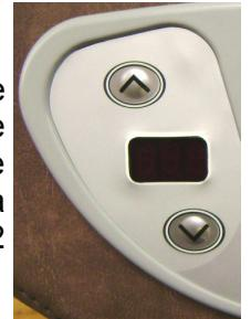
Pour régler la température, appuyer sur le bouton d'augmentation (^) ou diminution (v) de la température une fois pour afficher la température, puis utilisez ces boutons pour l'ajuster. La température choisie s'affichera pendant 5 secondes après avoir appuyé sur les boutons. Après cela, l'écran affichera à nouveau la température actuelle.
