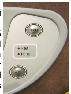
Nota: cuando la bañera está en standby durante el modo de funcionamiento nocturno o de ahorro de energía, aún puede pulsar el botón "JETS" para encenderlos durante 15 minutos. Una vez acabado el ciclo, los jets seguirán funcionando para calentar el agua hasta que alcance la temperatura que usted haya programado, tras lo cual volverán al modo standby. Si vuelve a apretar el botón "JEST" se apagarán de inmediato y la bañera volverá al modo standby.
