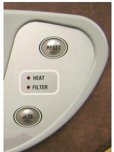
**ПРИМЕЧАНИЕ:** Для того, чтобы активизировать гидромассажные форсунки, когда спа находится в режиме ожидания или в режиме энергосбережения, нажмите кнопку «Jets»/«Форсунки» на панели управления. Форсунки включаются на 15 минут. По истечению 15-минутного периода форсунки будут продолжать работать для подогрева воды до установленного значения температуры. В этом случае, повторное нажатие кнопки «Jets»/«Форсунки» выключит гидромассажные форсунки, и спа незамедлительно вернется в режим ожидания.
