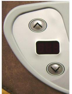
Para programar la temperatura, primero compruebe la temperatura actualmente programada pulsando una vez el botón con la flecha hacia arriba o el de la flecha hacia abajo. Luego; utilice los mismos botones para ajustar la temperatura deseada. Durante 5 segundos la pantalla indicará la temperatura que haya programado. Después, volverá a indicar la temperatura a la que se encuentra el agua.
